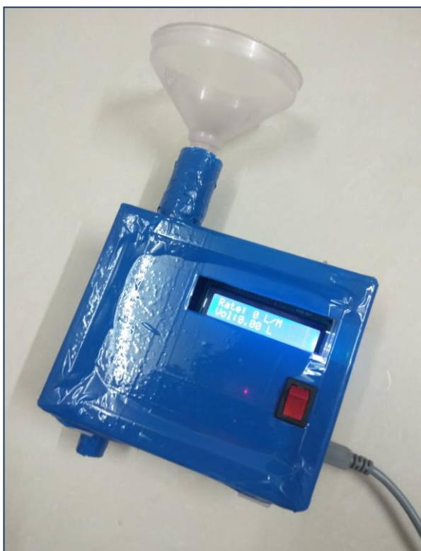
Fig. 8. Fuel Flow Meter
